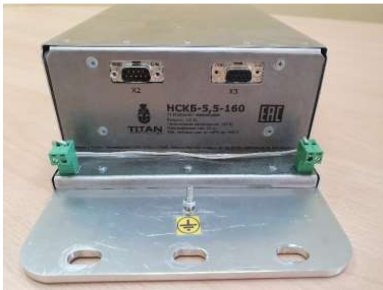
Рис. 3. Защитное заземление НСКБ-5,5-160.
