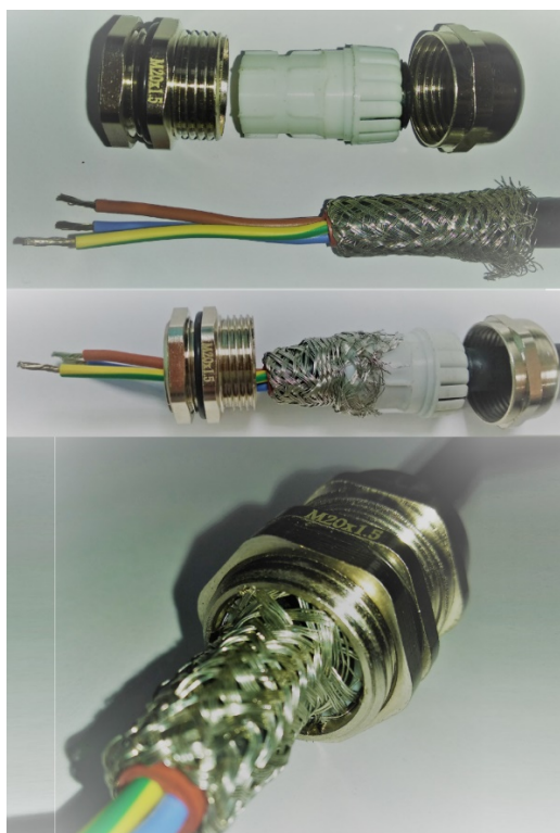
Рисунок 4. Пример разделки экранированного кабеля в гермовводе.
